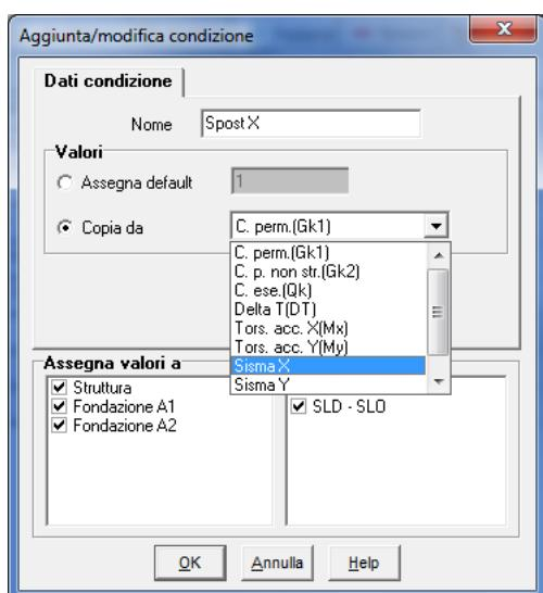
Ripetere l'operazione per gli spostamenti Y, copiando stavolta dal sisma Y. A questo punto, per non considerare doppiamente l'azione sismica, è necessario "azzerare" i coefficienti delle Azioni "Sisma X" e "Sisma Y". Per fare ciò selezionare la voce "Combinazioni personalizzate", posizionarsi in una cella dell'Azione voluta (es. Sisma X) e cliccare sulla funzione "Modifica" della condizione. A questo punto inserire il valore "0" al campo "Assegna default" e confermare con "OK":
