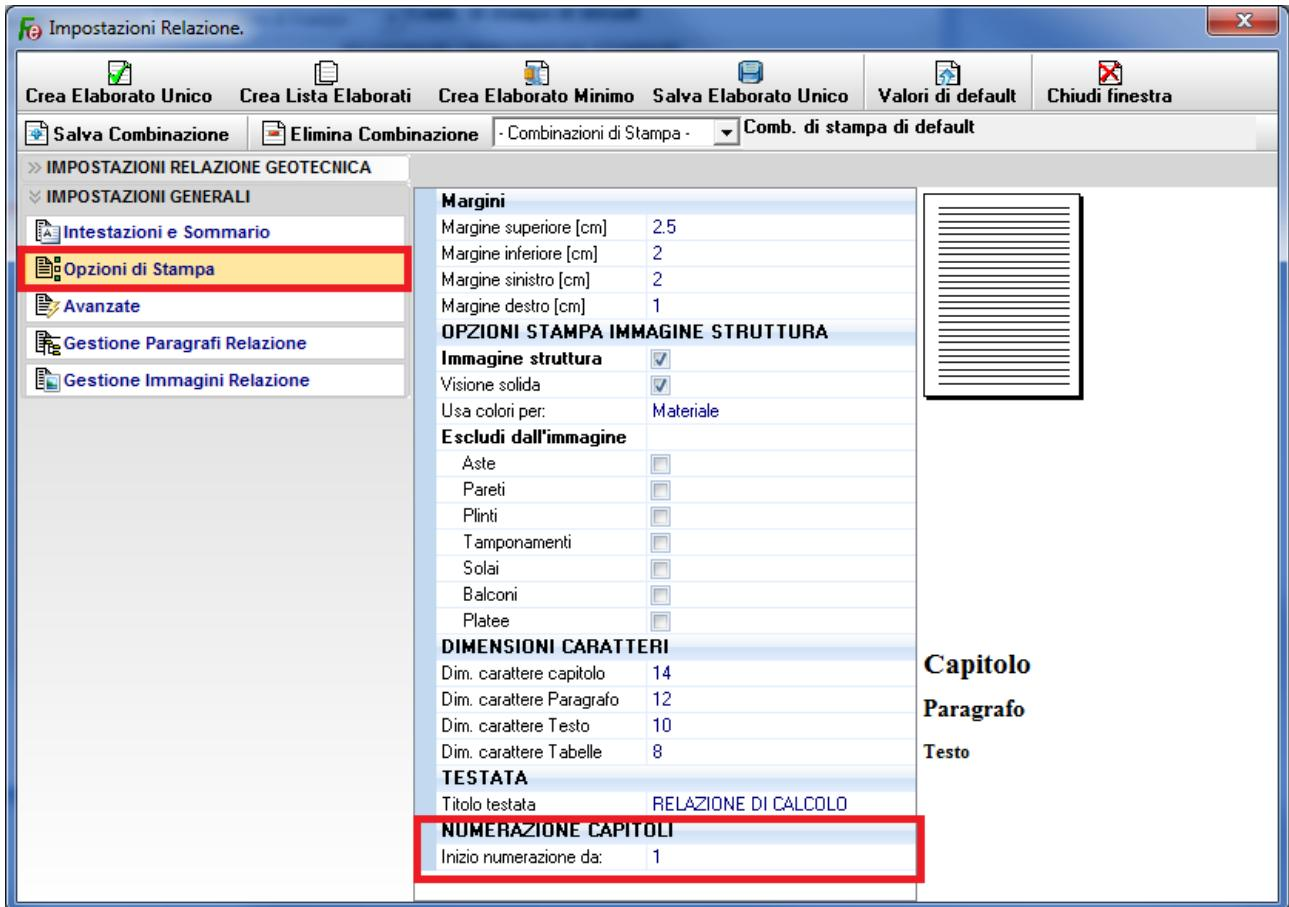
L'unica accortezza riguarda la scelta del valore da utilizzare per l'inizio della numerazione. Infine utilizzando un comune editor è possibile comporre in un unico file le tre relazioni (elaborate senza testata). Per generare un sommario unico, eliminare i sommari del file (1) e (2) e rigenerare solo il sommario del file (3), dopo aver "unito" i tre file.
