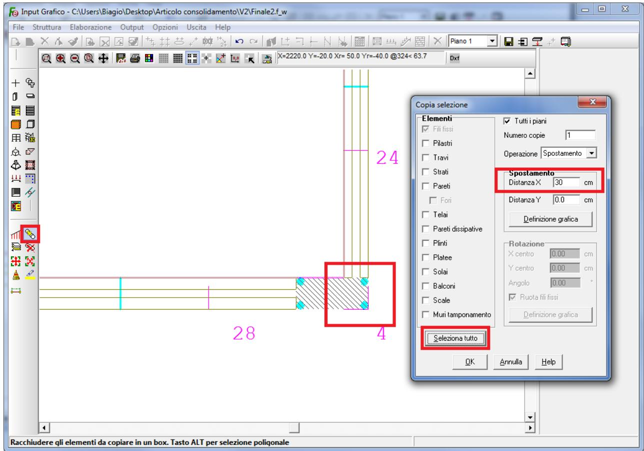
Dopo aver selezionato il filo “4” mediante il box, deselezionare tutte le voci e inserire la distanza “30” nel apposito campo, in modo da duplicare il filo ad una posizione di 30 cm spostato lungo X. Ripetere l'operazione per aggiungere tutti i fili necessari alla realizzazione della geometria.
