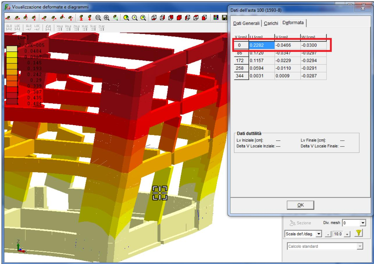
Dalla lettura dei valori di deformata, scegliamo la componente U, diretta lungo X Globale, e V, diretta lungo Y Globale. È importante evidenziare che il valore alla base degli spostamenti è praticamente nullo. Ripetendo l'operazione per gli altri elementi della pilastrata, otteniamo i seguenti valori (trascurando la componente non influente – es. U per la direzione Y):
