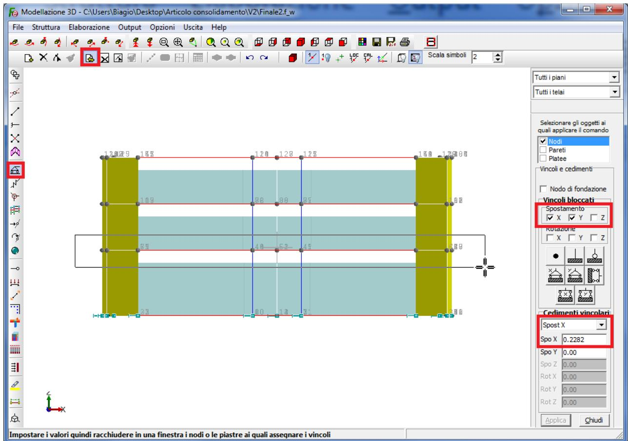
Ripetere l'operazione per gli altri livelli. Per assegnare lo spostamento Y, utilizzare il comando "Vincoli interni / Modifica". Selezionare un nodo del piano, assegnare all'azione "Spost Y" il valore 0.2272. Utilizzare il comando "Nodo / Copia Proprietà multiplo" per assegnare le stesse caratteristiche ai nodi dello stesso impalcato.
