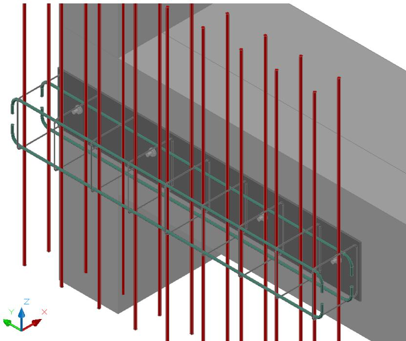
Questo tipo di connessione può essere modellato mediante degli elementi Shell, considerandolo come una piastra con le caratteristiche del calcestruzzo armato. L'inserimento della piastra avverrà con le funzionalità "Platee-Piastre/Introduci" selezionando i fili fissi di contorno":
