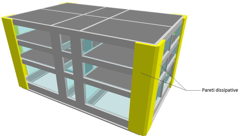
In fase di calcolo, per questo tipo di interventi, l'azione sismica deve essere assorbita dagli elementi di nuova realizzazione. Tuttavia, come richiesto nel punto C8.7.2.4, gli elementi esistenti dovranno essere oggetto di verifica di compatibilità degli spostamenti rispetto alla nuova configurazione consolidata ed agli spostamenti raggiunti dal sistema consolidato.
