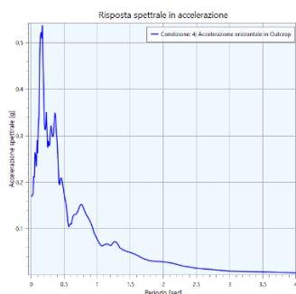
Figura 72. Grafico degli spettri di risposta in input ed in output per la condizione di carico corrente.
