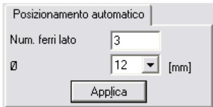
La pressione del pulsante "Applica", o il click all'interno della sezione, effettuano il posizionamento automatico lungo il bordo della sezione ristretto del copriferro.
