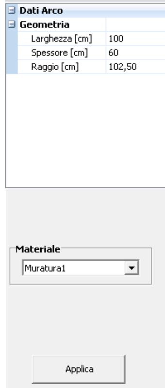
Le caratteristiche dell'arco (o delle volte) possono essere modificate editando i dati nelle caselle di testo riportate nella precedente figura. E' possibile modificare la **Larghezza** (dimensione ortogonale a quella del piano dell'arco), lo **Spessore** ed il **Raggio** (vedi figura successiva).
