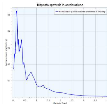
Figura 40. Grafico degli spettri di risposta in input ed in output per la condizione di carico corrente.
