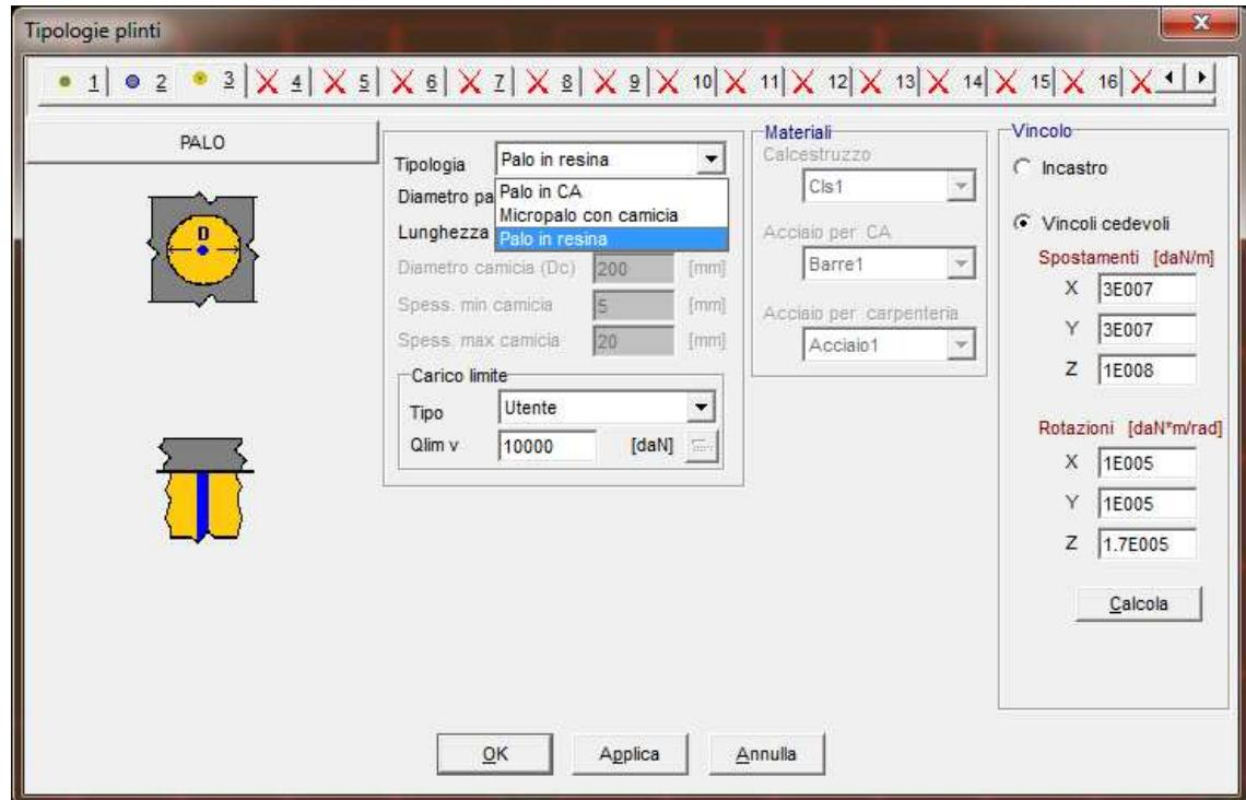
Per i pali in resina oltre alle caratteristiche geometriche il software consente di definire il carico limite da Utente, assegnando il valore del carico limite rilevato
