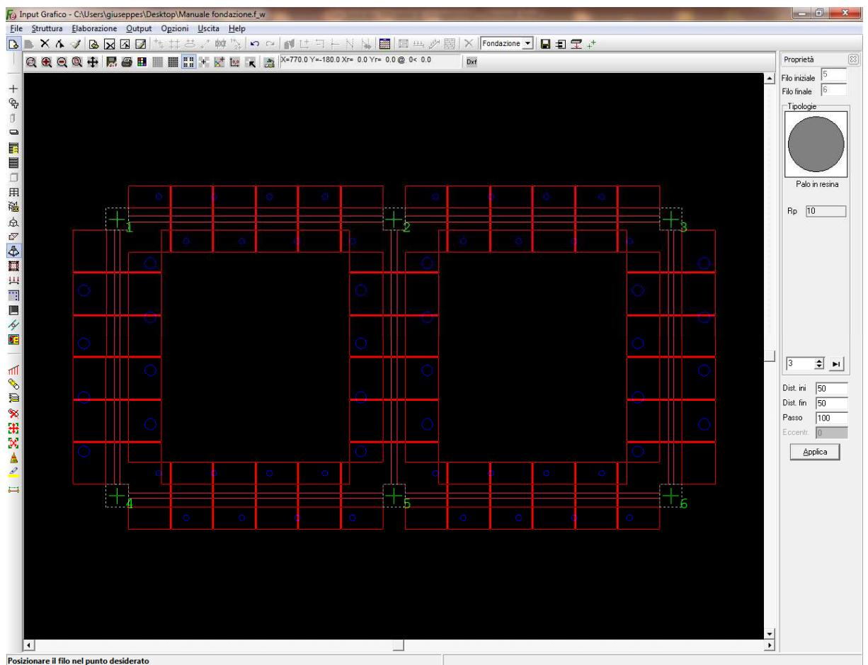
Selezionando la tipologia di palo fra le tipologie di plinto tipo 13 edificate
