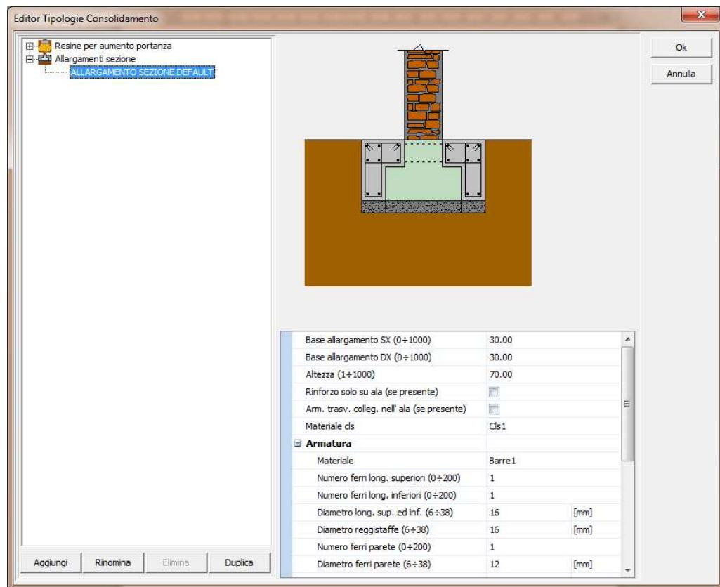
L'editor delle tipologie di consolidamento allargamento della sezione permette di dimensionare l'allargamento della sezione a destra ed a sinistra della sezione esistente di assegnare le armature longitudinali e trasversali per ogni allargamento e di personalizzare il collegamento alla struttura esistente.
