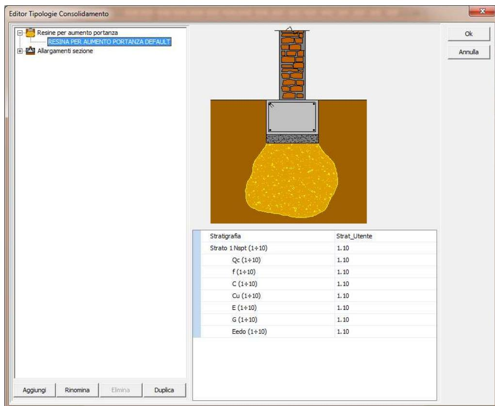
Per il consolidamento del terreno di fondazione tramite resine espandenti il software consente di assegnare l'incremento delle caratteristiche meccaniche, per la stratigrafia in esame, rilevate da prove in situ successive alle iniezioni di resine oppure stimate in fase di progetto e da verificare con ulteriori prove in situ.
