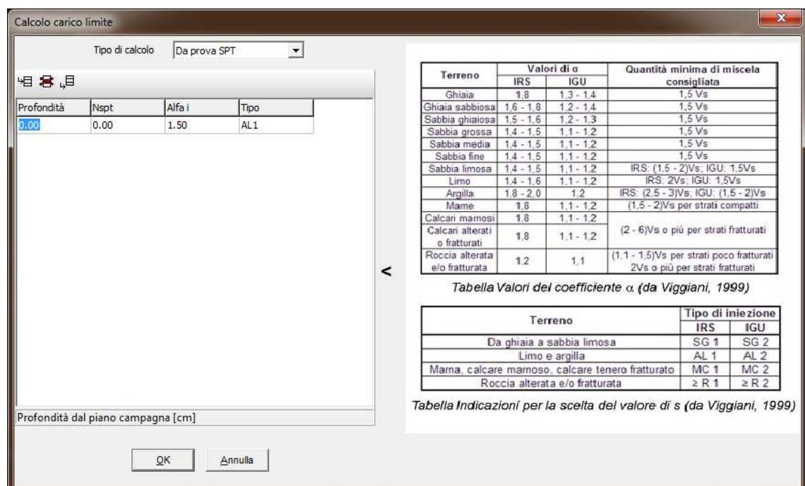
direttamente da prove di carico, oppure da Prove in sito inserendo i parametri necessari per il calcolo del carico limite di progetto per pali iniettati.
