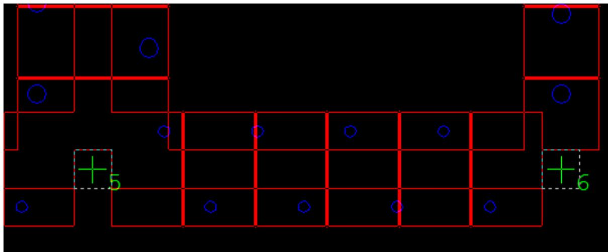
Per le travi di fondazione non consolidate il software consente di inserire un'unica fila di pali con gli stessi parametri richiesti per la trave consolidata ed in più la possibilità di attribuire un'eccentricità in cm dei pali rispetto all'asse della trave .
