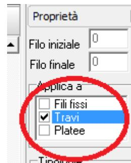
Selezionando l'inserimento dei pali sotto travi di fondazioni il software consente di definire la singola trave di fondazione oppure il gruppo di travi di fondazione consolidate oppure no, in cui inserire le fondazioni indirette.
