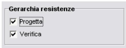
È importante non disattivare l'opzione "Verifica"!! E' possibile che nonostante sia stata scelta la progettazione non sia possibile ottenere una soluzione legata all'incremento delle armature.
