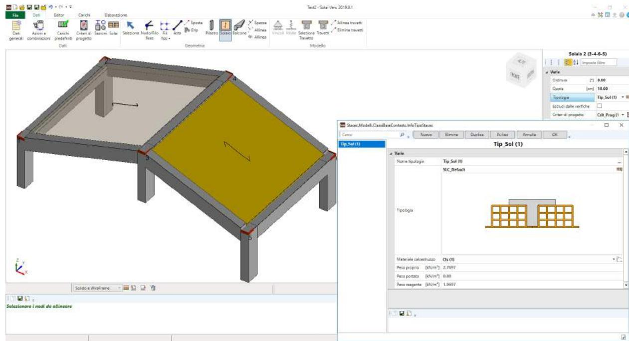
Il modello di calcolo del solaio viene realizzato **modellando tutti i travetti** che compongono l'impalcato, considerando anche la possibilità del “*modello a trave continua*”. Ciò consente, anche nell'ambito della stessa campata, di progettare ogni travetto impostando i diversi di **armatura personalizzata** in base alla lunghezza del singolo elemento.
