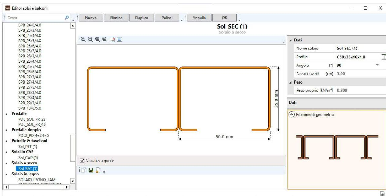
Il solaio viene definito partendo dal profilo scelto dall'editor profilati. Il calcolo del peso viene effettuato automaticamente dal software.
