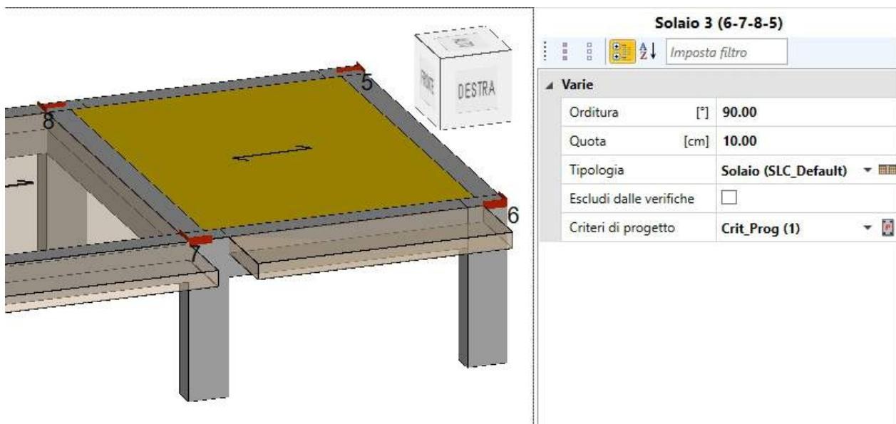
La barra delle proprietà fornisce informazioni sul solaio e consente di effettuare operazioni di input o di modifica dei parametri.
