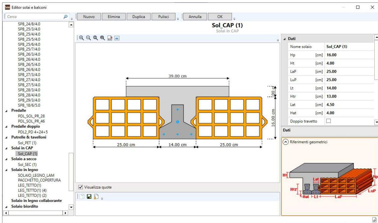
I dati geometrici per la definizione del solaio in esame sono desumibili dalla figura di seguito riportata:
