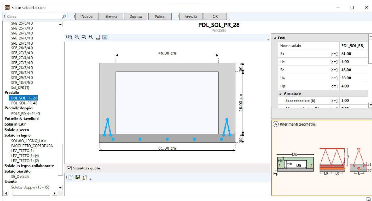
I dati geometrici e quelli sulle disposizioni delle armature per la definizione del solaio in esame sono desumibili dalla figura in basso a destra (Riferimenti geometrici) della finestra precedente.
