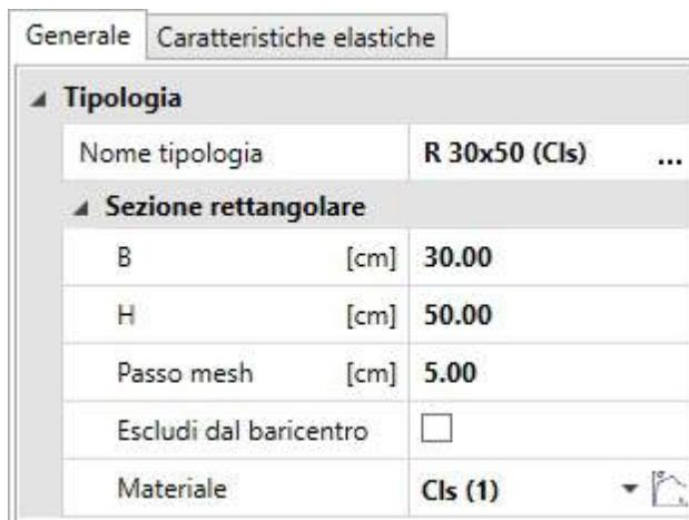
E' possibile, inoltre, visualizzare le caratteristiche elastiche della sezione aggiunta:
