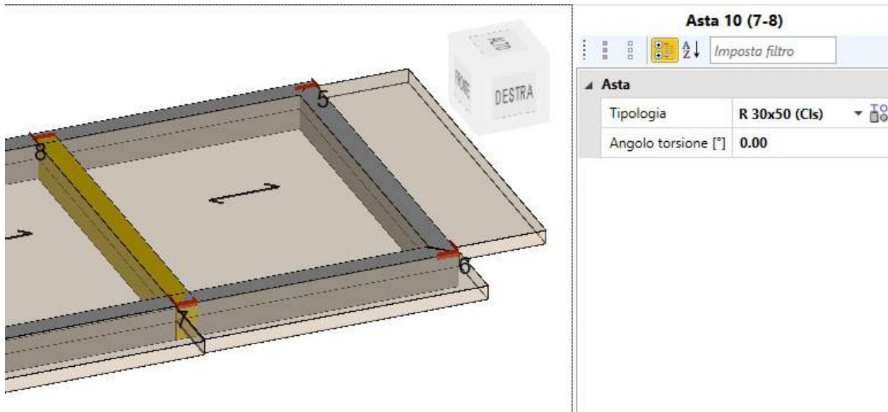
La barra delle proprietà fornisce informazioni sull'asta e consente di effettuare operazioni di input o di modifica dei suoi parametri.
