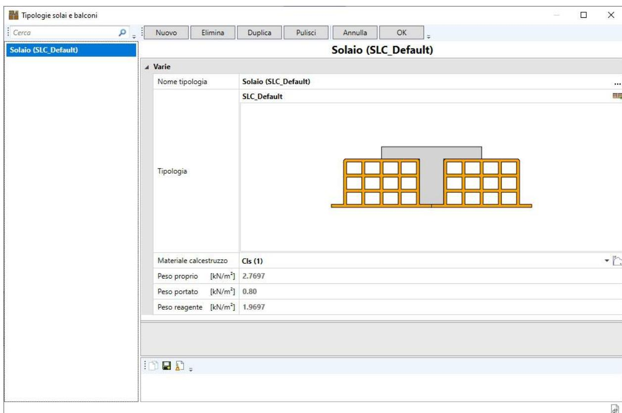
Sulla parte superiore dell'ambiente **"Tipologie solai e balconi"** sono presenti i pulsanti per la gestione delle tipologie di solai necessari alla implementazione del modello.
