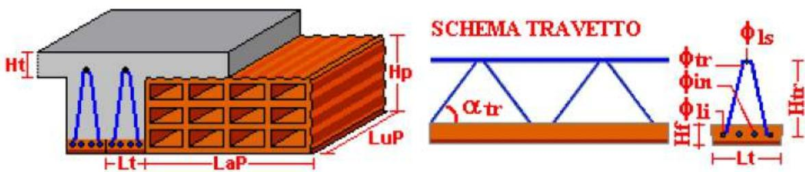
Il peso proprio del solaio viene calcolato automaticamente dal programma, il quale richiede anche il peso per unità di superficie relativo alle pignatte.
