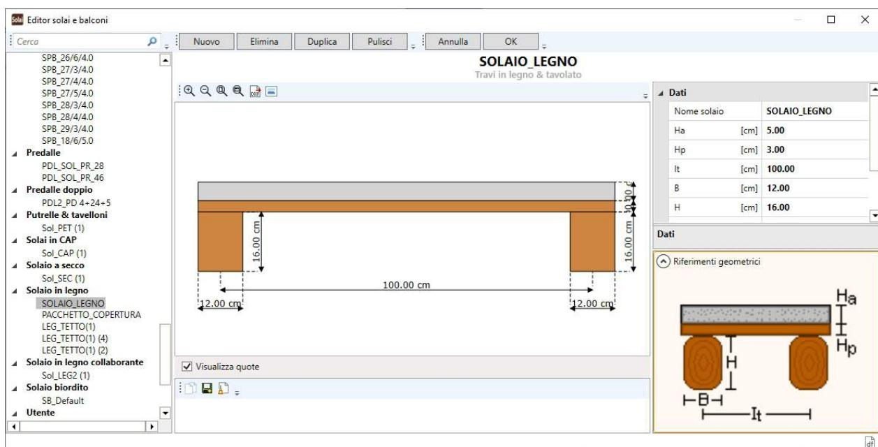
I dati geometrici per la definizione del solaio in esame sono desumibili dalla figura di seguito riportata:
