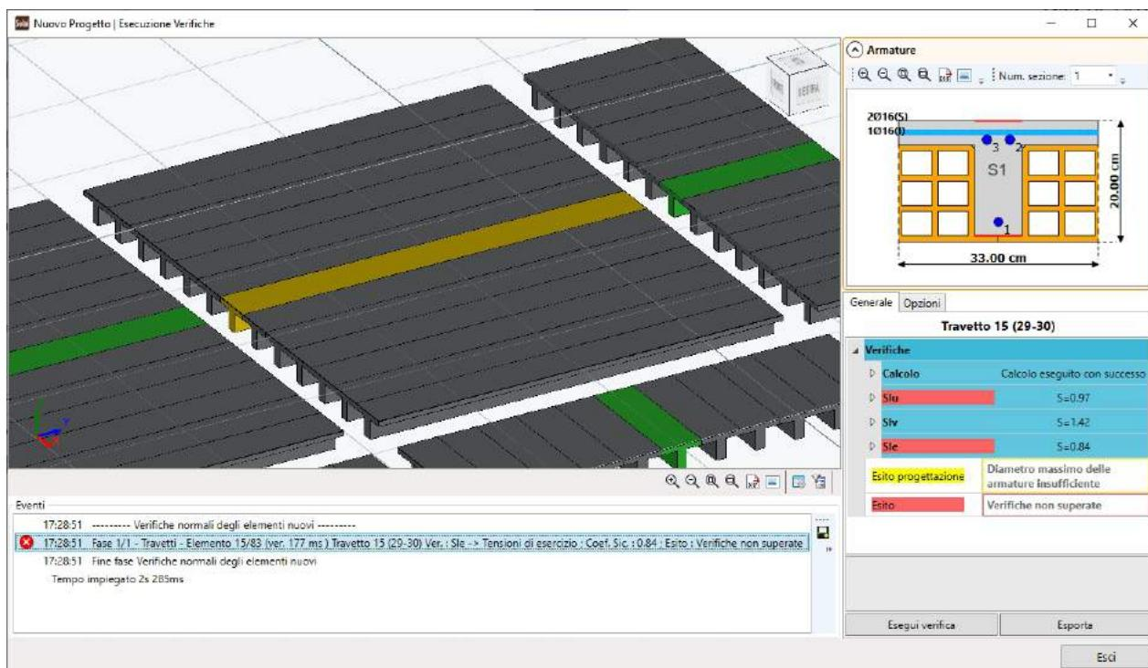
Cliccando su un qualsiasi travetto del solaio è possibile visualizzare i risultati delle verifiche relative all'elemento selezionato.
