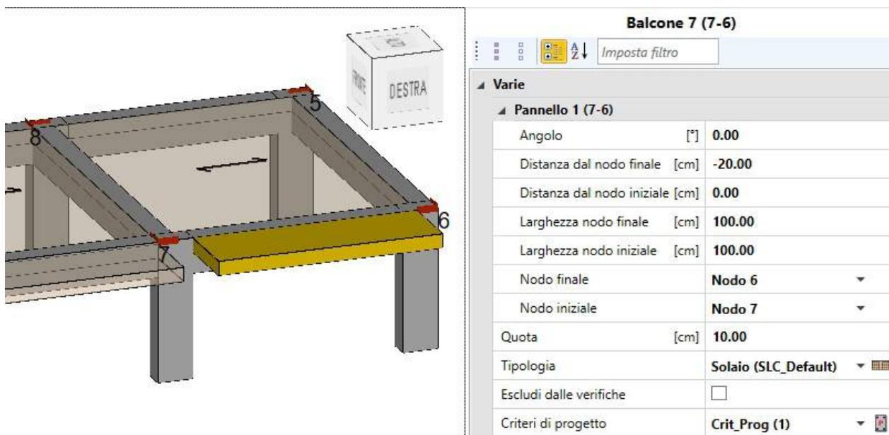
La barra delle proprietà fornisce informazioni sul balcone e consente di effettuare operazioni di input o di modifica dei parametri.
