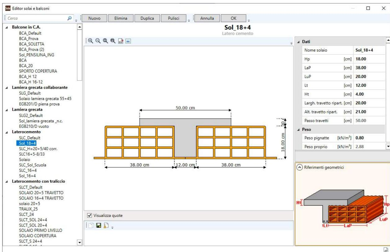
I dati geometrici per la definizione del solaio in esame, desumibili dalla figura in basso a destra (Riferimenti geometrici), sono i seguenti:
