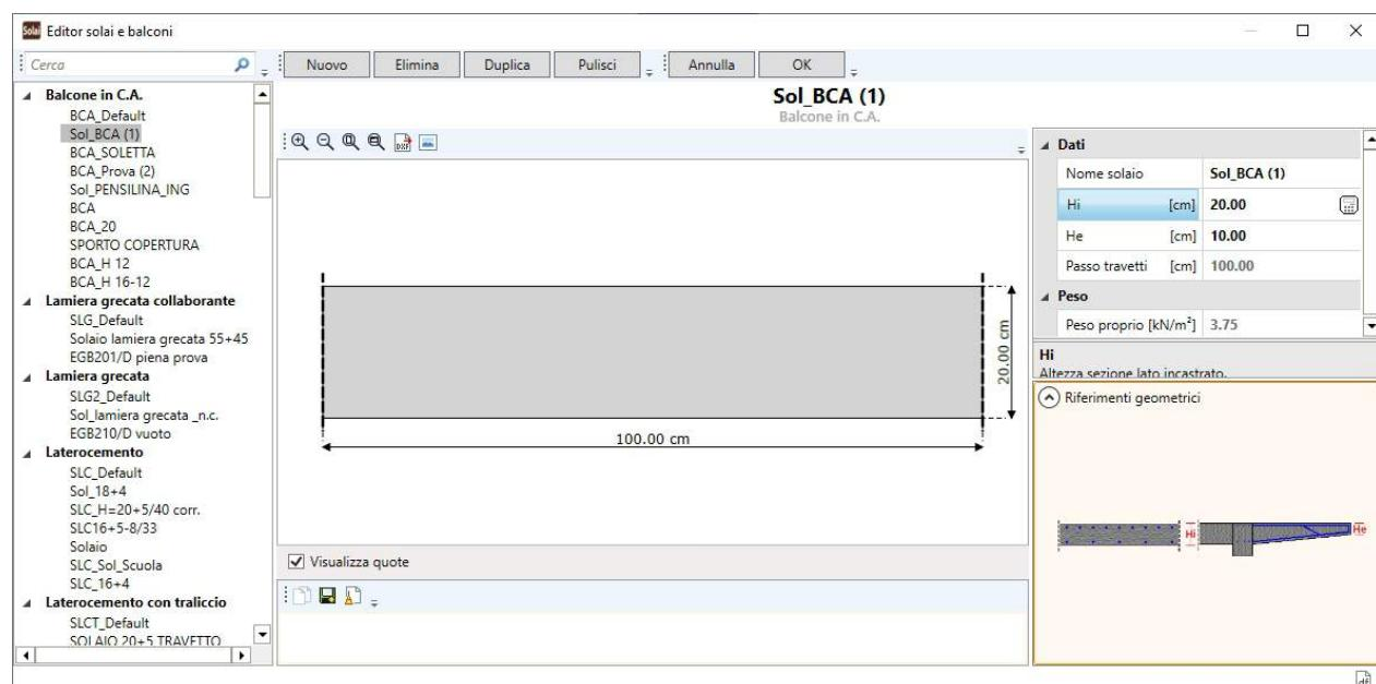
I dati geometrici per la definizione del solaio in esame, desumibili dalla figura in basso a destra (Riferimenti geometrici), sono i seguenti:
