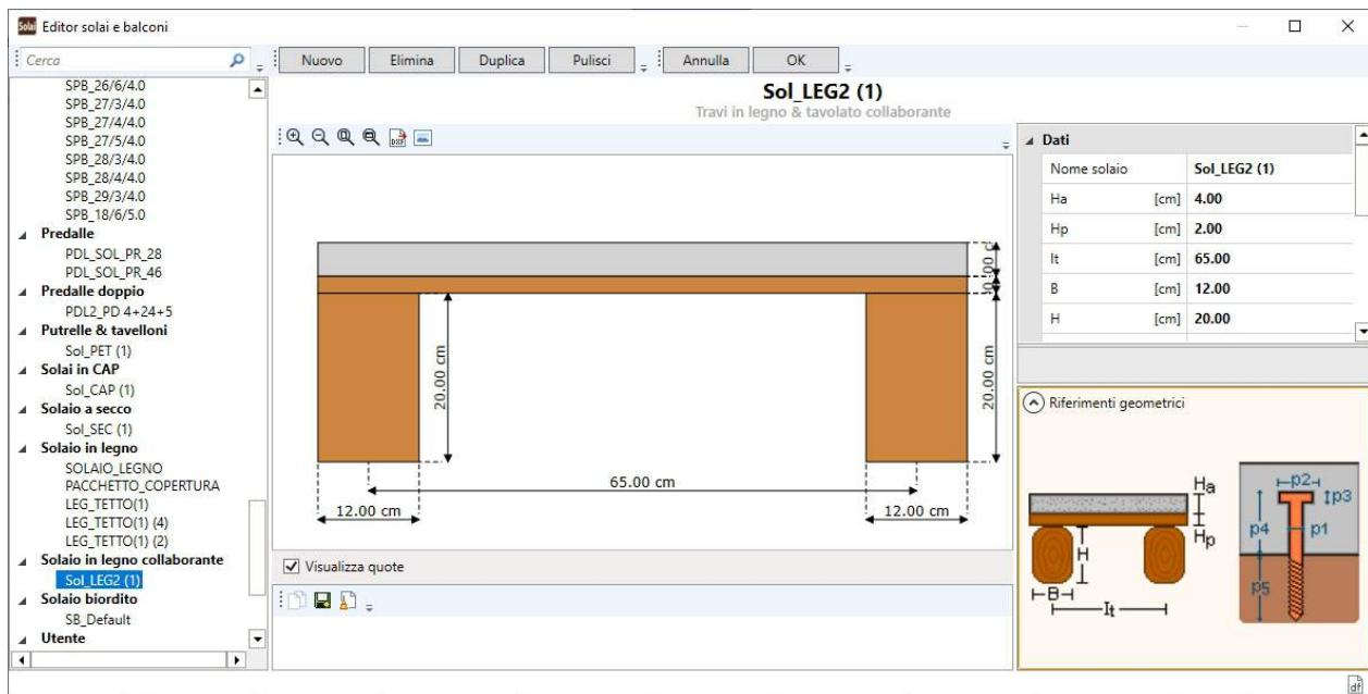
I dati geometrici per la definizione del solaio in esame nonché le caratteristiche dei pioli connettori sono desumibili dalla figura in basso a destra (Riferimenti geometrici) della finestra precedente.
