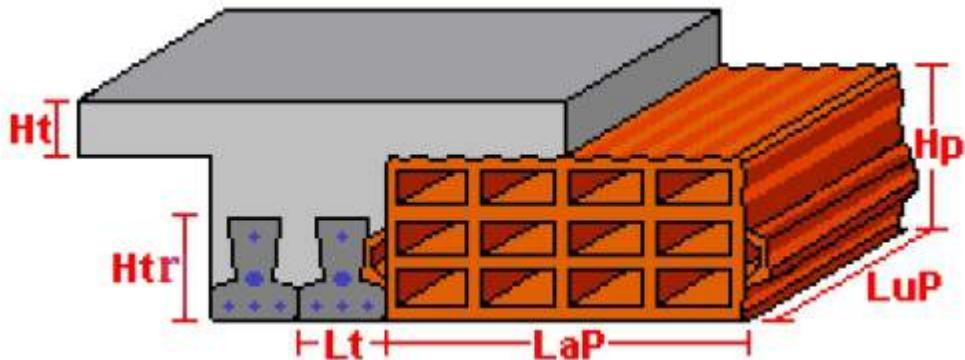
Come possiamo notare dalla figura precedente per questa tipologia di solaio è possibile scegliere se utilizzare il singolo oppure il doppio travetto. E' possibile introdurre i travetti ripartitori che vengono automaticamente introdotti quando la luce del singolo solaio supera i 5 m. Il peso proprio del solaio viene calcolato automaticamente dal programma, il quale richiede anche il peso per unità di superficie relativo alle pignatte.
