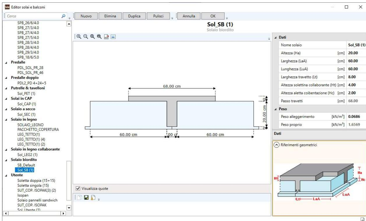
I dati geometrici per la definizione del solaio in esame sono desumibili dalla figura in basso a destra (Riferimenti geometrici) della finestra precedente.
