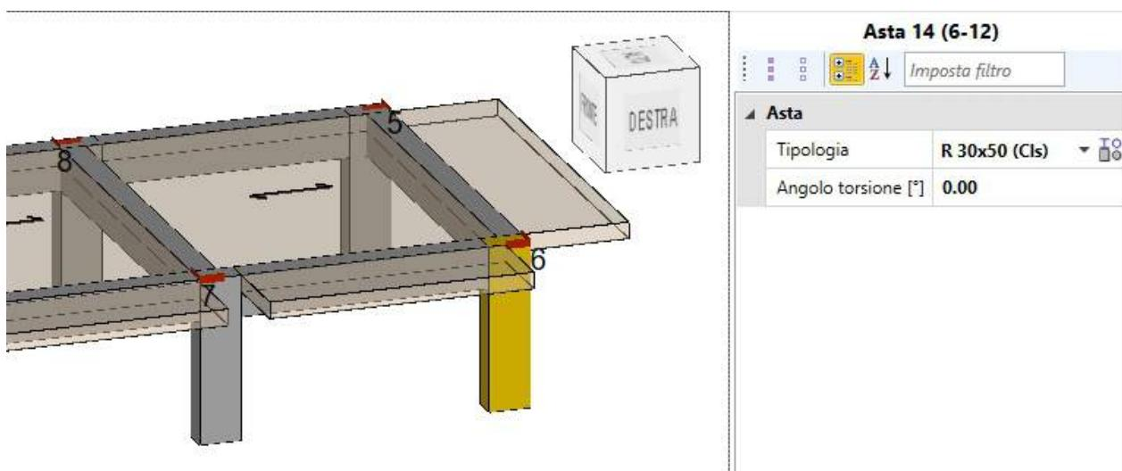
**N.B.** Bisogna tenere presente che i pilastri inseriti nel modello, al pari delle aste, non verranno sottoposti a verifica ma servono solamente per definire la geometria del solaio in esame.
